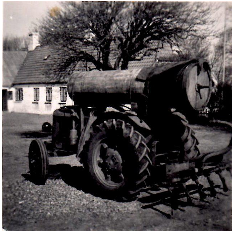
Ajleaggregat kunne betjenes fra traktorens førersæde
